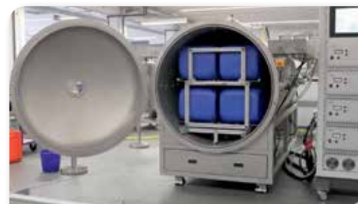
Rys. 5. Komora próżniowa urządzenia firmy Diener o pojemności 2800l umożliwia modyfikację powierzchni nawet dużych przedmiotów
