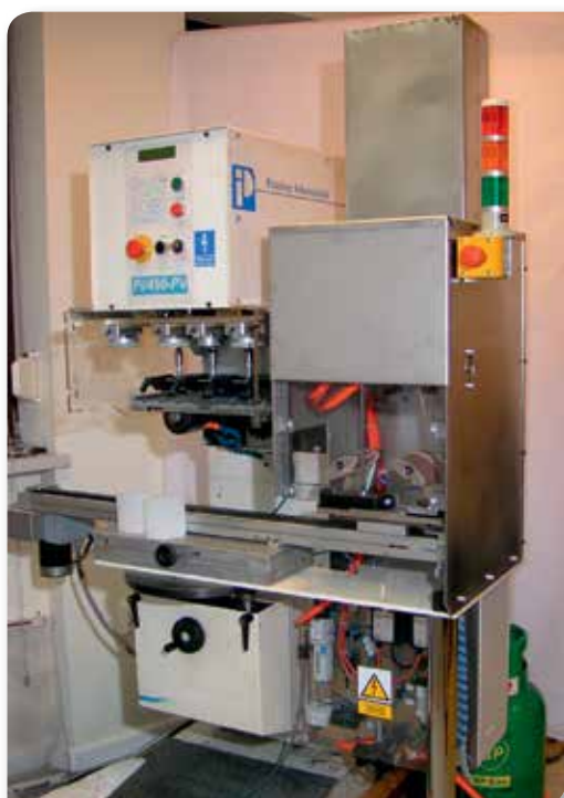
Rys. 3. Stanowisko aktywacji pojemników z PP zintegrowane z tamponiarką
