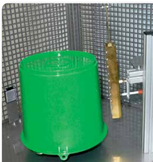
Rys. 2. Aktywacja płomieniowa powierzchni wiadra z PP przed nadrukiem
